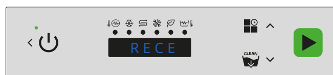
Funcția RECE dezactivată
