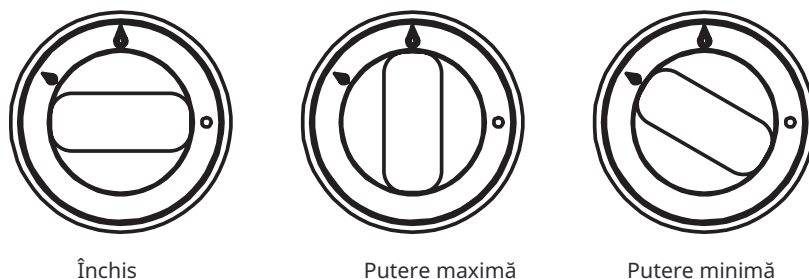
Fig. 1 Poziția butonului robinetului de gaz pentru arzătoarele de suprafață
