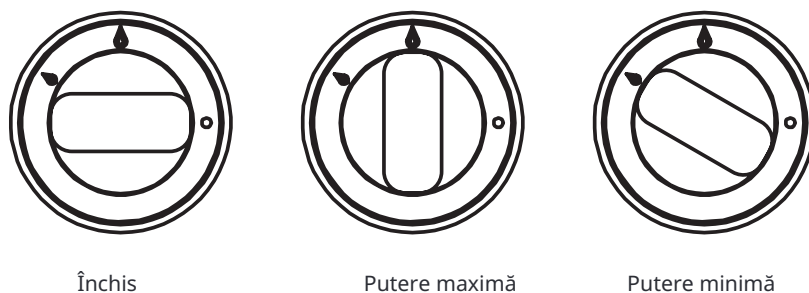
Fig. 1 Poziția butonului supapei de gaz a arzătoarelor de suprafață
